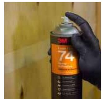
**Winkel:** Halten Sie den Klebstoff einen Winkel von 90° zur Oberfläche für optimale Abdeckung
