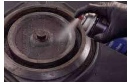
3M™ Industriereiniger und Klebstoffentferner entfernt Klebstoff, ohne die darunter liegende Oberfläche zu beschädigen.
