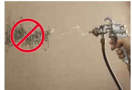
3M™ Sprühklebstoffe in Flaschen zerstäuben keine Spritzbilder mit zusätzlicher Luftleitung. Das bedeutet, dass Sie konsistente, gleichmäßige Spritzbilder erhalten, wodurch Sie möglicherweise Nacharbeiten und Aufräumarbeiten einsparen können.
