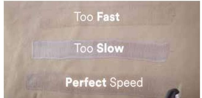
**Geschwindigkeit:** Achten Sie auf eine konstante Geschwindigkeit beim Auftragen von Klebstoff
