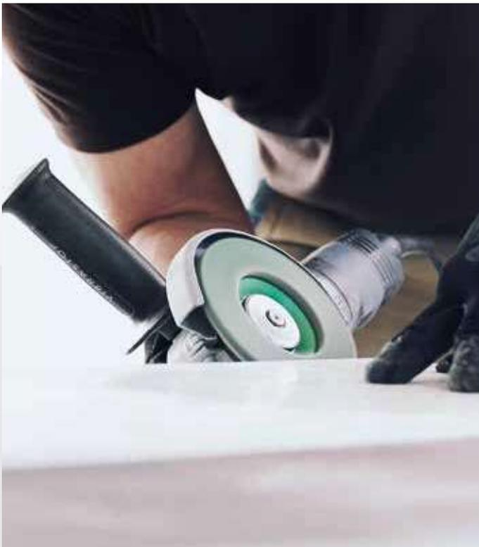
Schleifscheiben haben eine normale 22,23er Bohrung und M14-Gewinde. Das M14-Gewinde kann direkt auf die Maschine geschraubt werden und ermöglicht einen schnelleren Scheibenwechsel!
