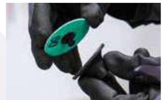
Schnellwechselsystem mit einem Dorn, der in den Aufnahmeteller geschraubt werden kann, für sichere Befestigung und schnellen Austausch.
